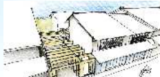
空地部分に門型ラーメン補強を施し、耐震性を向上させる。
